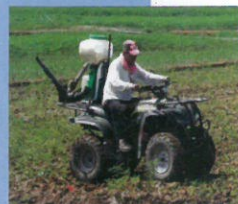
沙灘車搭載動力餌劑撒佈機
