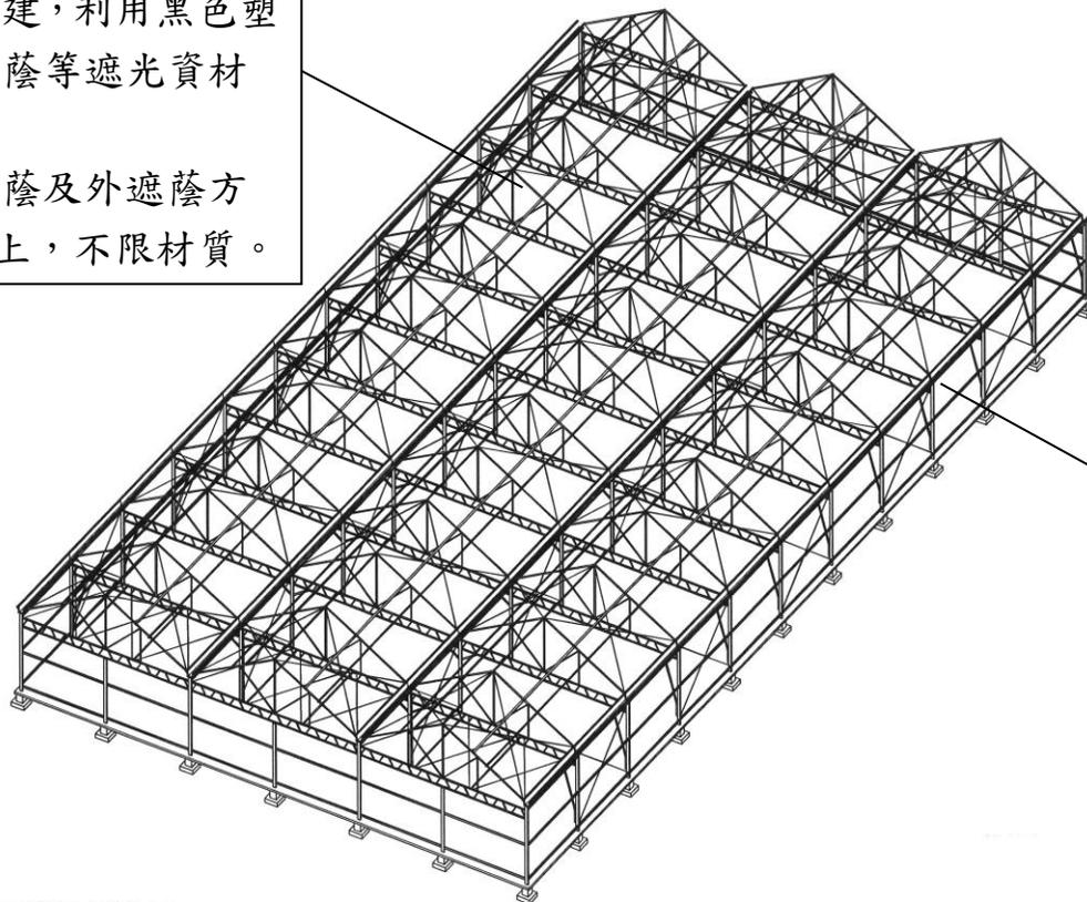
周邊披覆資材以玻璃、硬質塑膠(如玻璃纖維強化聚脂、壓克力、PC 等)、軟質塑膠膜布(F-CLEAN、PO、PET、PE、EVA 等)、塑膠網等溫網室透光材質，可增設捲揚式遮光網調控光照。
