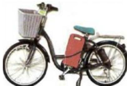
ยานพาหนะสองล้อที่ผ่านการทดสอบรับรองมาตรฐานตามประเภทของรถ ที่ขับเคลื่อนด้วยพลังงานไฟฟ้าเป็นหลัก มีความเร็วในการขับขี่สูงสุดต่ำกว่า 25 กม./ชั่วโมง และน้ำหนักรถ(ไม่รวมแบตเตอรี่) ต่ำกว่า 40 กก. หรือน้ำหนักรถ(รวมแบตเตอรี่) ต่ำกว่า 60 กก.
