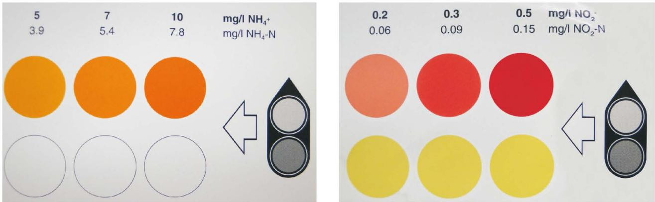
圖2、氨（左）與亞硝酸（右）檢驗套組的比色表中，上方一排的數字為氨與亞硝酸的檢測值，水產養殖用途的水質檢測應該對照這排數字；下方一排的數字為氨氮與亞硝酸氮，是水草養殖缸用途的水質檢測對照用，水產動物相關業者要注意別比對錯誤。
