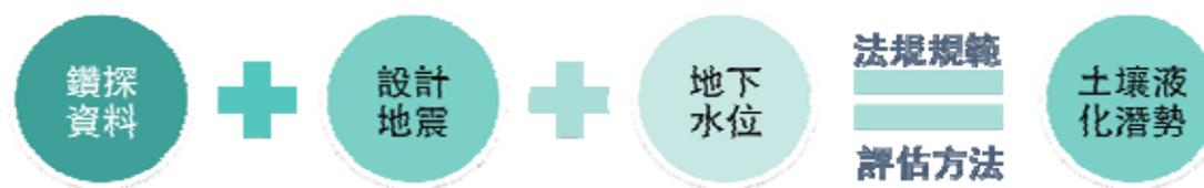
2. 設計地震為土壤液化評估所採用之地震設計，依建築法規，選擇發生週期為每 475 年發生一次，最大震度的地震，各地區地震造成的地表加速度值因地震之震源位置、震源機制、傳播路徑及基地之地盤性質等改變，而略有不同，一般約為 0.24 g – 0.4 g。如臺北所採用之加速度值為 0.24 g，屬於 5 級震度，宜蘭為 0.32 g，屬於 6 級震度。
