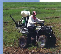
沙灘車搭載動力餌劑撒佈機
