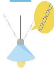
防止吊掛式照明燈具掉落
