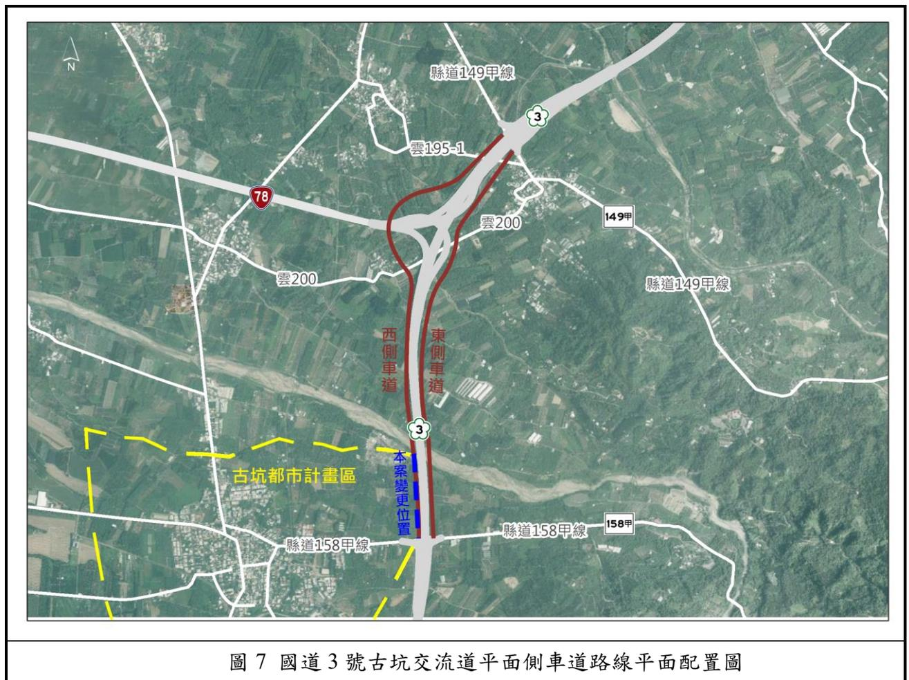
圖 7 國道3號古坑交流道平面側車道路線平面配置圖
