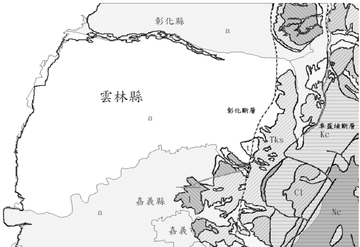
圖2-07 斗六市附近30公里範圍內活斷層分佈圖。彰化斷層(47)、車籠埔斷層(26)、九芎坑斷層(1)、古坑斷層(19)、梅山斷層(36)、大尖山—觸口斷層(4)。
