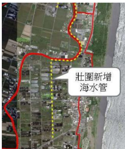
圖 3-3-27(上) 壯圍養殖漁業生產區新增海水供管線位置
